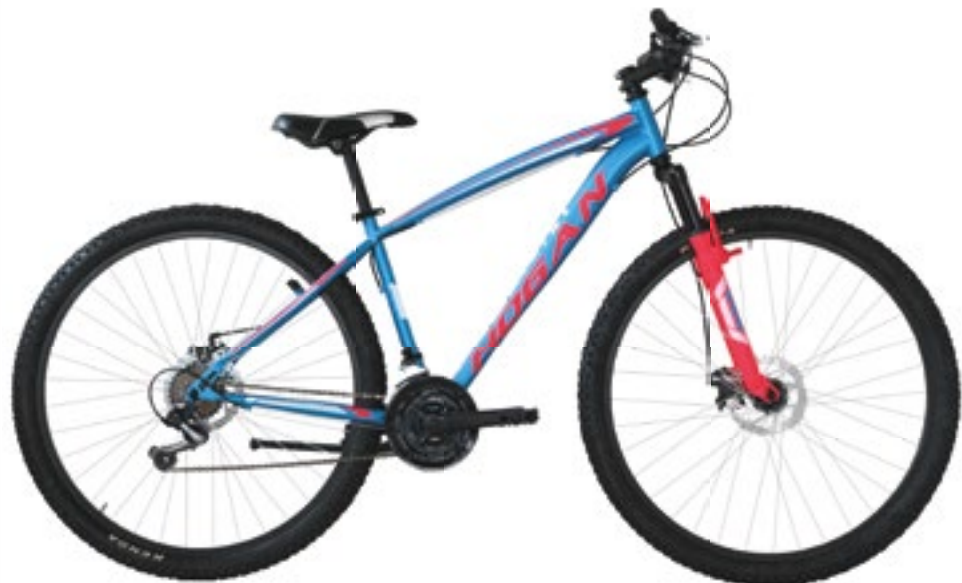
MOUNTAIN BIKE 27,5" 21V telaio in acciaio, forcella ammortizzata, cambio Shimano 21 velocità, comandi Saiguan grip, freno anteriore a disco meccanico, freno posteriore V-brake
